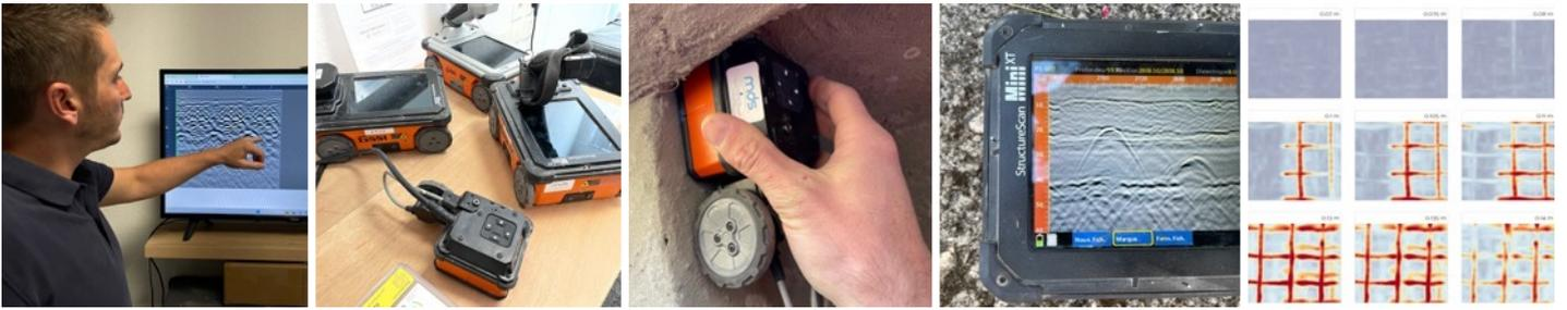
La méthode radar a de nombreuses applications dans le domaine des structures et ouvrages de génie civil. Une large gamme de matériels et antennes existe, permettant d'ausculter les structures plus ou moins profondément, et **de moyenne à très haute résolution**.
