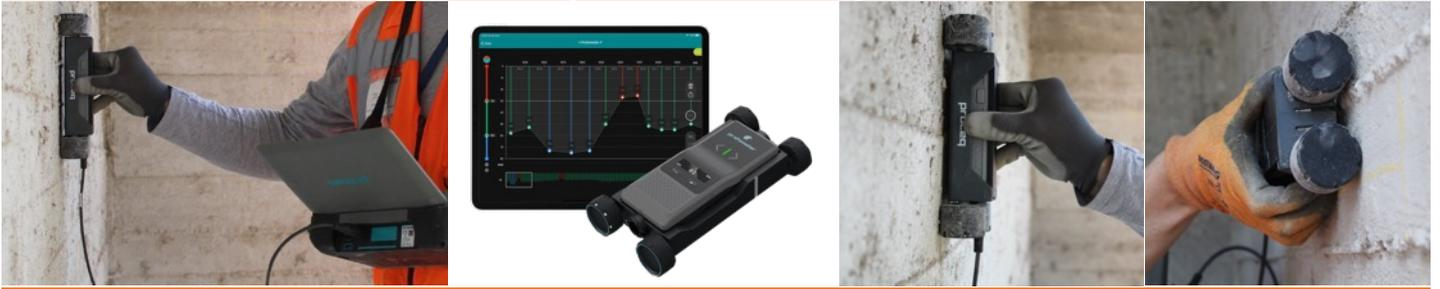
Avant travaux de carottages ou perçages dans les structures en béton armé, ou tout simplement pour contrôler l'enrobage, le nombre et les emplacements des aciers présents, il est souvent demandé de réaliser une campagne de détection des armatures.
