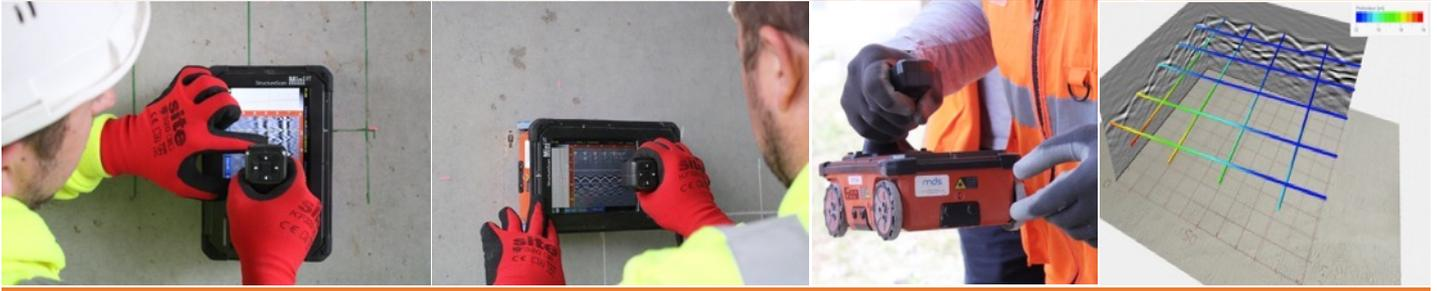
Lors de travaux de carottages ou perçages dans des structures de génie civil (voiles, dalles, poutres, massifs ..), il est souvent demandé de réaliser au préalable une **détection des armatures**, gaines de précontrainte, chauffage au sol, câbles électriques ou canalisations. Les plans existants sont souvent peu précis ou parfois même inexistantes.
