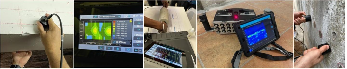
La mesure ultrasonique du béton, basée sur les méthodes de vitesses d'impulsion et d'écho d'impulsion, fournit des informations sur la qualité et l'uniformité du béton, et sur la présence de vides, ségrégations, délaminations, fissures, défauts, gaine, etc.
