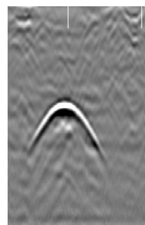
Réseau AEP en fonte
